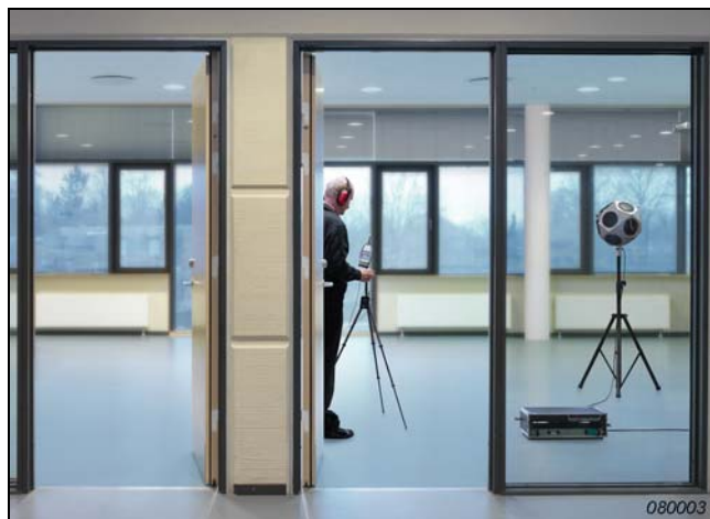
Fig. 7 Medición del tiempo de reverberación mediante el método de ruido interrumpido
