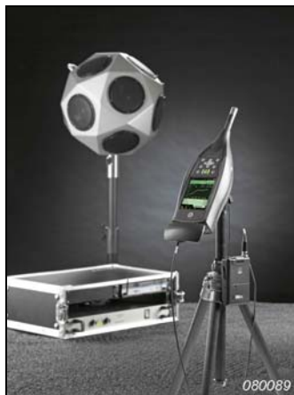
Fig. 10 Existen sendos sistemas inalámbricos opcionales para controlar la medición del aislamiento acústico de las fuentes al ruido aéreo (izquierda) y de impacto (derecha).
